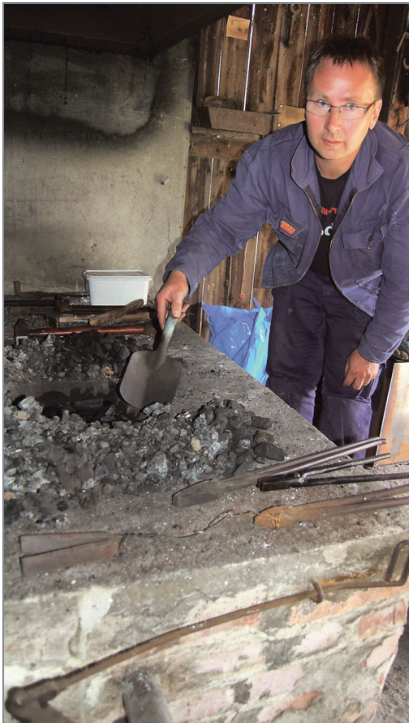
Varmen må opp i 1000 grader og når det begynner å sprute stjernesudd kan en begynne å smi. (Foto: Torunn Henriksen)
