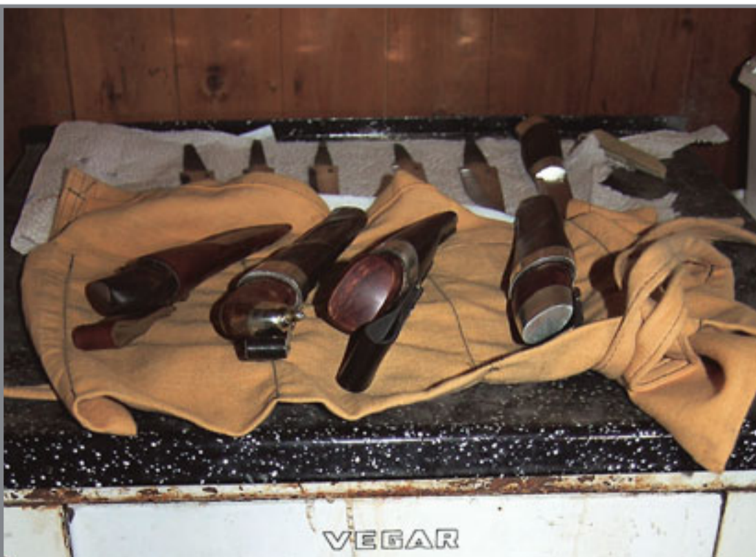
Både slipemaskin og stekeovn er kommet i drift igjen, og denne bruker Anstein til anløping etter at knivbladet er herdet.
